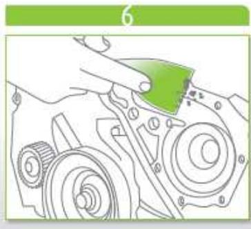
Valeo recommande de nettoyer la surface de contact entre le moteur et la pompe à eau afin d'assurer une bonne étanchéité.
