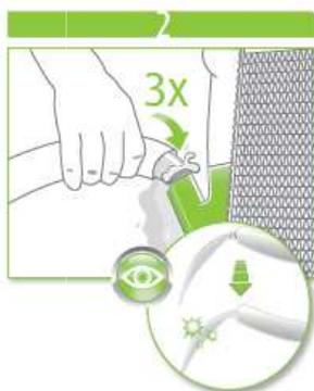
Le rinçage du circuit de refroidissement, y compris radiateur et durites, permet d'éviter le déplacement d'impuretés qui peuvent provoquer une défaillance de la pompe à eau. Valeo recommande de répéter l'opération 3 fois.
